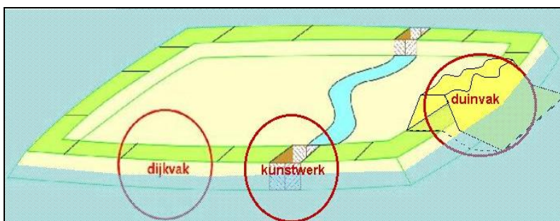
Figuur 10: De dijkkring als een keten met verschillende schakels.
