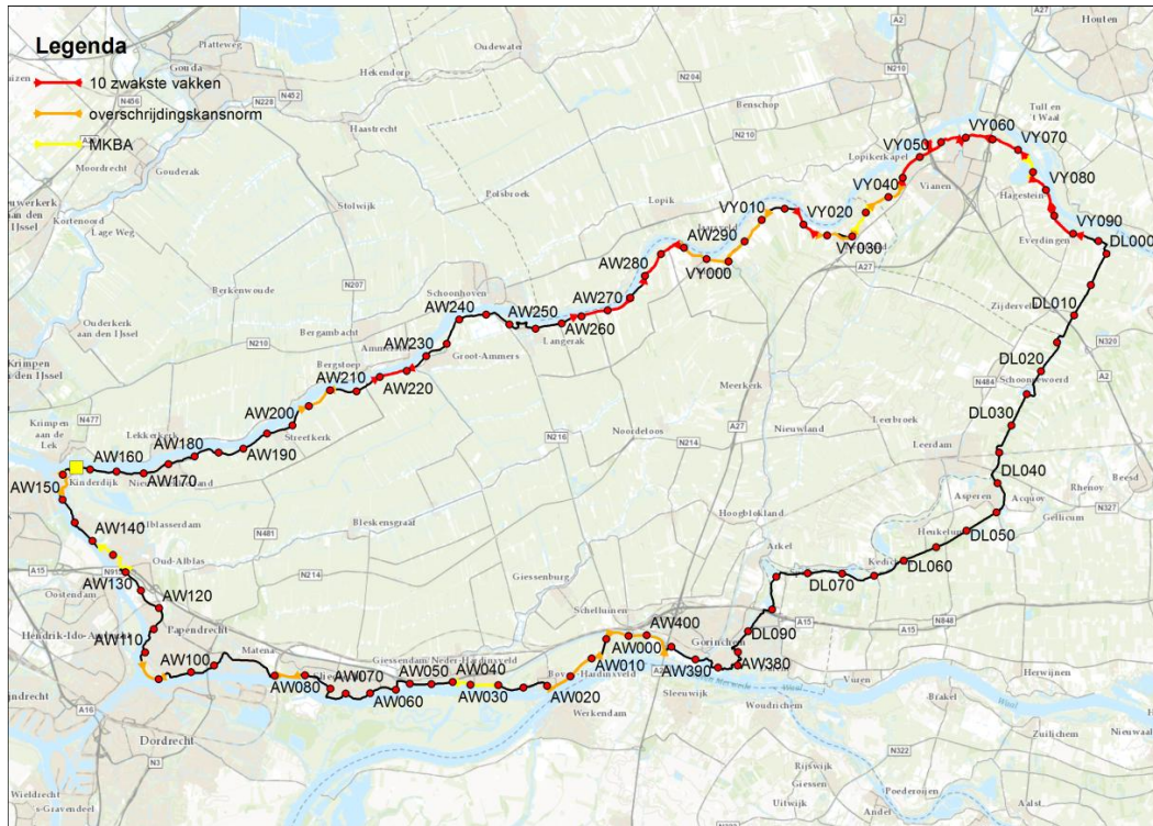
Figuur 88: Te verbeteren dijkvakken en kunstwerken om de overstroomingskans gelijk te krijgen aan de overschrijdingskansnorm of de optimale kans uit de MKBA.
